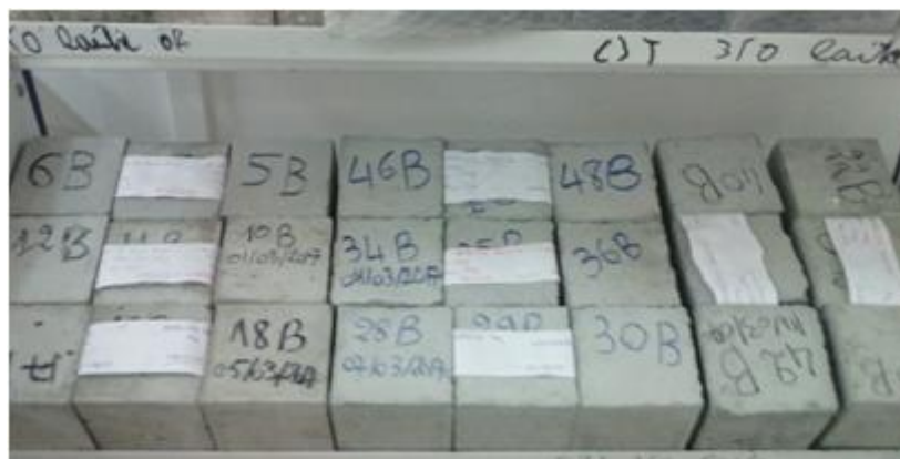
Fig(III.6) : Conservation des éprouvettes a l'air libre.
