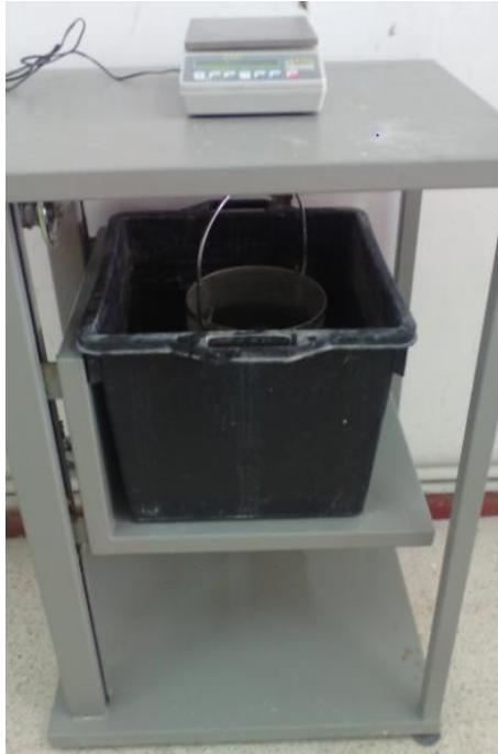
Fig(III.7) : Essai de porosité à l'eau.
