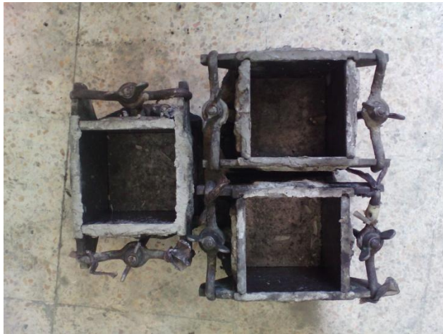
Fig(III.3) : moules des mortiers utilisés.
