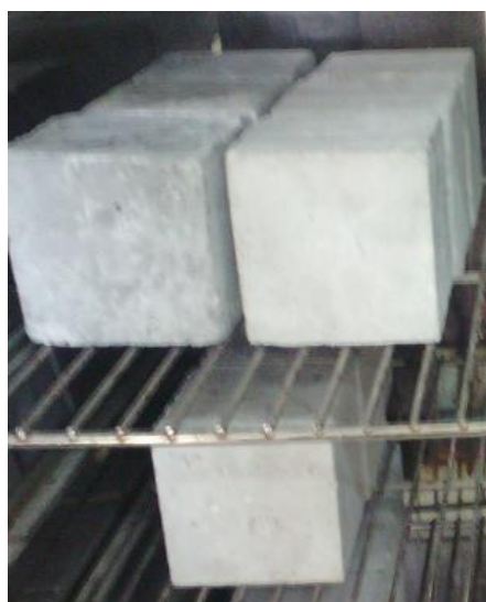
Fig(III.8) : Conservation des éprouvettes dans le tuve. .
