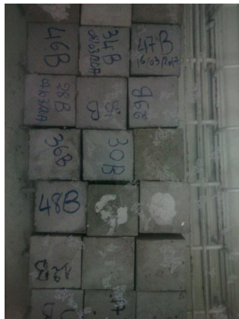
Fig(III.5) : Conservation des éprouvettes dans l'eau.
